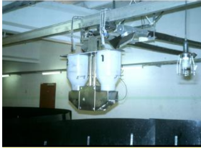
Şekil 4. Bir ray sistemine bağlı motorlu bir yemleme robotu.
