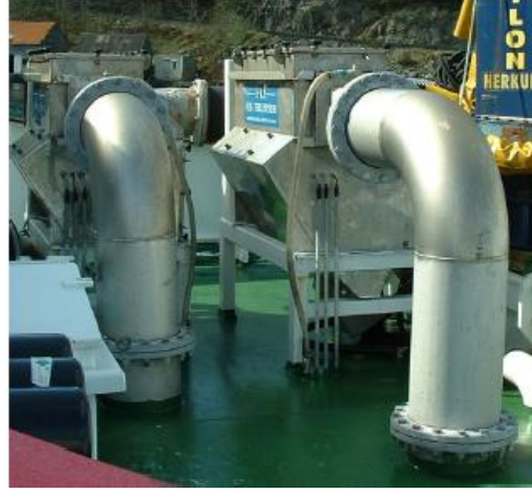
Şekil 7. Balık boyunu ölçmek için bir tekneye yerleştirilen video kameralı bir birim.
